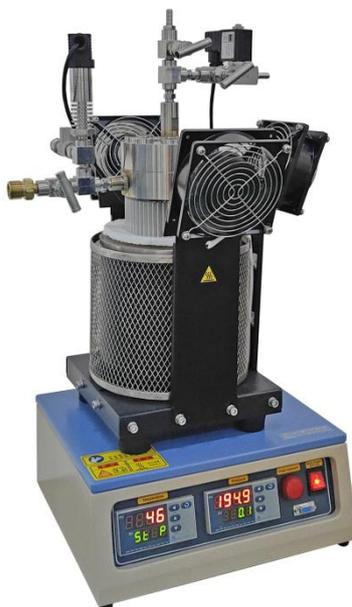
RC-Ni100/RC-Ni200 的高温高压反应釜，采用镍基高温合金钢制作，其具极高的蠕变强度和抗氧化性。反应釜可承受最高温度为 1100℃（此时反应釜内可承受的压力高达 4MPa）。此款设备适合用水热法制备材料，也特别适合在高压氧环境下对样品进行热处理。
