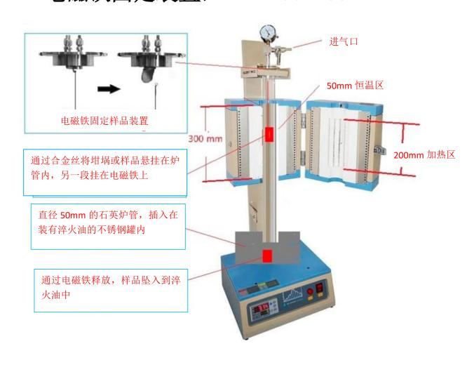
VT-1200X-50 是一款小型的淬火炉,配有直径为 50mm 石英炉管,最高温度可达 1200℃。一个电磁铁固定装置安装在顶部法兰内侧用于挂样品或坩埚,将样品置于炉体加热区中心。电磁铁可自动释放样品坠入到淬火油中。石英管底部插入到装满淬火油的不锈钢罐中,通过通入惰性流动气氛保证气密环境下淬火。
