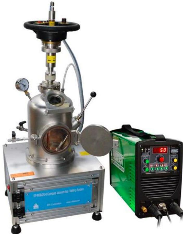
SP-MSM208 是一款小型电弧熔炼炉，带有真空吸铸工位，可对特殊样品熔炼后进行铸造（铸造出样品直径 **6mm**，棒状，最大量 **30g**），铸造过程：熔炼样品被快速抽到一个铜模中，样品快速进入铜模，快速冷却凝固，可减少样品缩孔缺陷。设备上安装有一机械操作手，可在熔炼过程中翻转样品。
