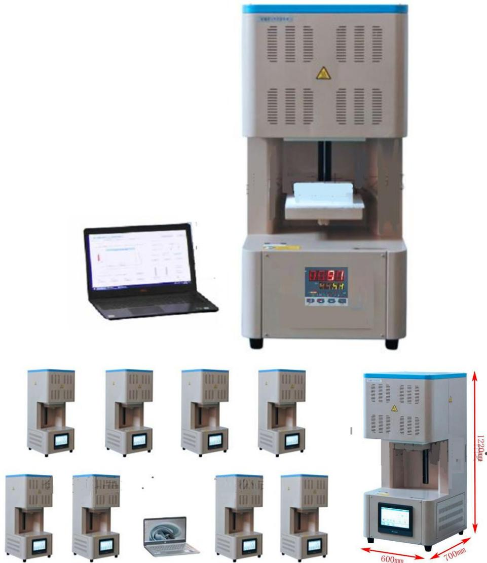
VBF-1700X-L8AX 是一款自动化下装载箱式炉，最高温度可达 1700℃。此款箱式炉可以通过电脑和一键自动化操作：关门、升温、保温、降温和开门。也可兼容与机器人达到自动放样、取样和记录。一个 PC 可同时控制 8 台高温炉。
