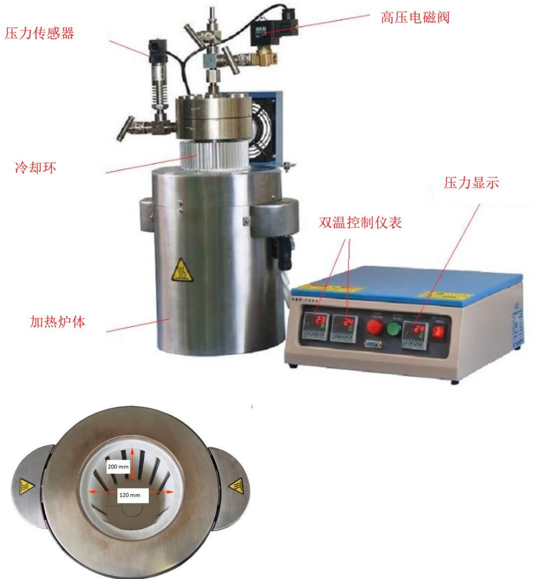
GSL-1100X-NI-1500 是一款 1500ml 的立式高温高压反应釜，材质为镍基合金钢，具有特别好的蠕变强度和抗氧化性。设备最高使用温度 1000℃，此温度下最大气压 1MPa(氧或惰性气体环境)。这个高温高压反应釜非常适合用水溶液发合成探索新材料，也可对一些材料在高压氧环境下热处理。同时也可作为蒸汽发生器使用。
