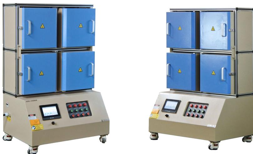
KSL-1500X-MGI-4 是一款 1500℃ 四通道箱式炉，其炉膛尺寸 120\*120\*120mm，可用于采用高通量方法对多个样品进行热处理，最高温度可达 1500℃，每个加热模块都有独立的温控系统控制，可同时放 4 个样品，在不同的温度下处理样品。该设备占地小，能耗低，是高校、科研院所工、矿企业做高温烧结、质量检测用的理想产品。此设备特别适合用于探索新一代材料的相图。
