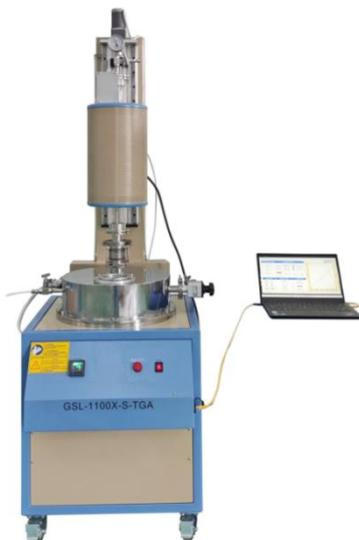
热重分析法 (TG, TGA) 是在升温、恒温或降温过程中, 观察样品的质量随温度或时间的变化。此款热重分析炉广泛应用于塑料、橡胶、涂料、药品、催化剂、无机材料、金属材料与复合材料等各领域的研究开发、工艺优化与质量监控。
