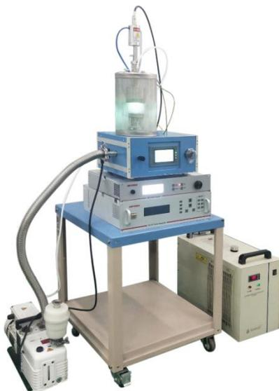
VTC-2RF-STX 是一款小型的单靶磁控溅射镀膜仪,配有一个 2 英寸的磁控等离子溅射头。射频等离子电源和高压直流电源两种电源可选,用于镀膜各种薄膜材料
